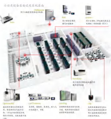
(a) 卡乐面向数据机房集成控制系统
