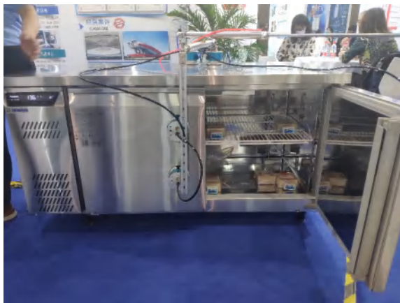
图7-7 国家商用制冷设备质量监督检测中心开门试验控制系统
