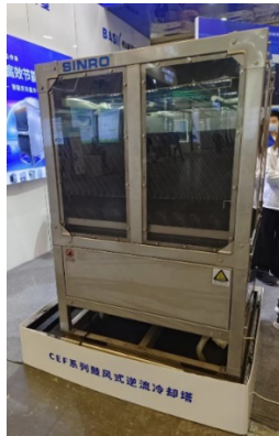
图2-14 新菱鼓风式逆流冷却塔
