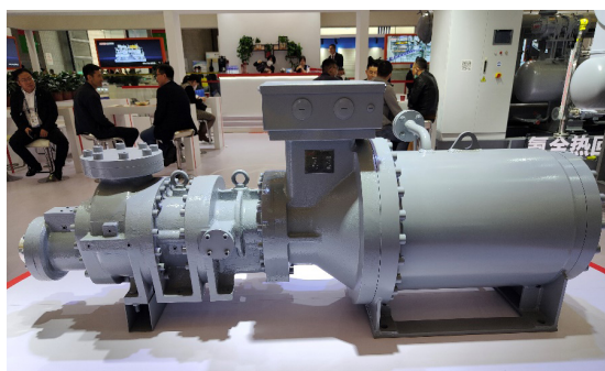
图7-2 奥威制冷内容积比可调半封压缩机
