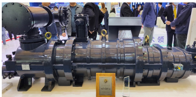
图7-3 上海汉钟精机LT-S-200/100-IVX全配置双级变频螺杆机
